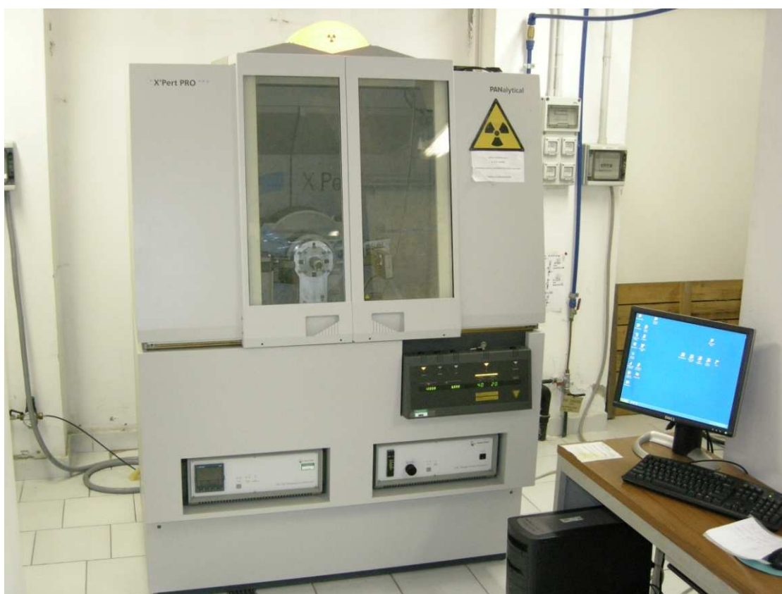
Fig. 10 Diffrattometro per polveri X-Celerator (PANalytical), utilizzato per le analisi diffrattometriche.
